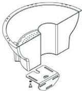
Metallbefestigung für runde Masten Ø max 120 mm / Ø >120 mm
